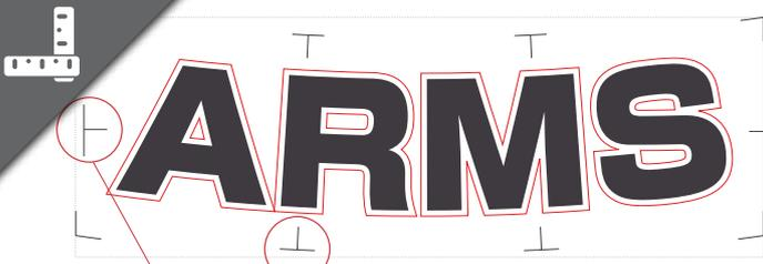
Die mittleren Markierungen in Richtung der X- und Y-Achse sind einstellbar.
