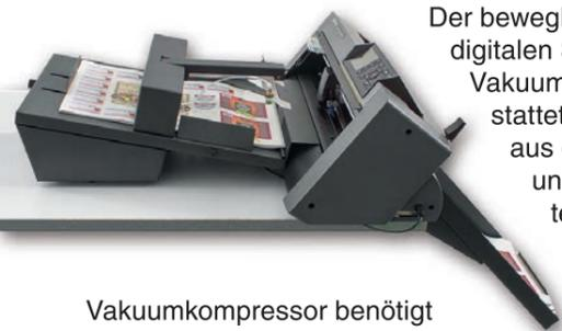
Der bewegliche Arm der digitalen Stanze, der mit einer Vakuumsaugung ausgestattet ist, hebt die Blätter aus dem Eingabefach und führt sie dem Plotter zu. Der interne
