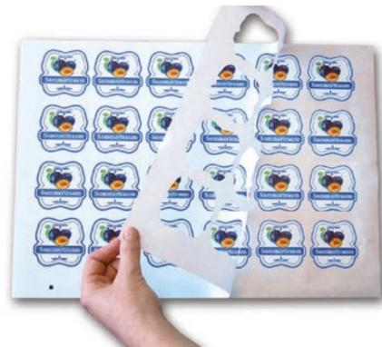
Das Ausschneiden wird im Perforationsmodus ausgeführt. Dabei werden in gleichmäßigem Abstand kleine Materialbrücken erhalten die dafür sorgen, dass das Material während des Schneidens nicht zerfällt. Die Schneideparameter werden in dem Programm gesetzt.
