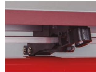
Umschalten des Push-Roller-Andrucks (CE6000-120)
